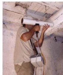
Fig. 5 - Avaliação da integridade de elementos de madeira com Resistograph
